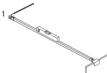
Umriss der Halterung -1- kennzeichnen und die Mitte ankörnen, Bohren und Dübeln.
